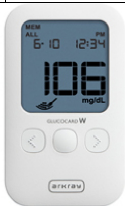
GLUCOCARD W - прибор для самостоятельного контроля уровня глюкозы в крови
