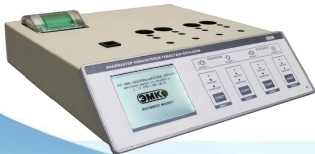
Оптико-механические коагулометр с сенсорным графическим экраном и каналом для хромогенных тестов
